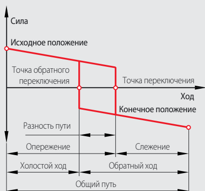
Диаграмма управления выключателя мгновенного действия
