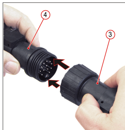
Abb. 25: Stecker (3) und Dose (4) so verbinden, dass Nuten und Führungen leicht ineinandergleiten
