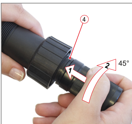
Abb. 19: Kontakteinsatz mit Hilfe des Verriegelungswerkzeugs in das Gehäuse montieren
