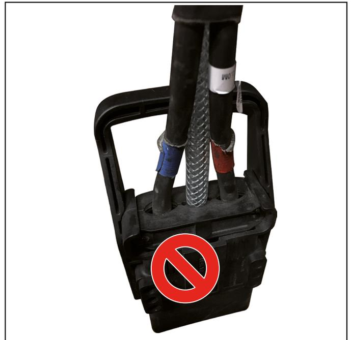
Abb. 7: Unzulässige Verlegung; Gewebeschlauch entspricht nicht den Anforderungen der Spezifikation
