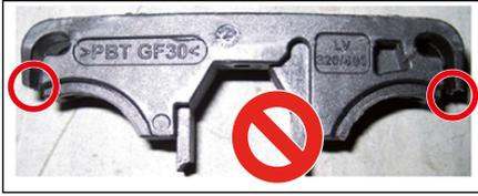
Abb. 24: LV 320/400 S Schieber mit beschädigten Rasthaken
