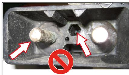
Abb. 12: Linker Stift Kontakt verschmutzt auf Grund von Säureeinwirkung, Kodierstift fehlt
