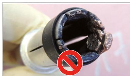
Abb. 13: Buchsenkontakt mit Material-Auf- oder Abtrag
