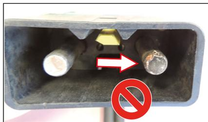
Abb. 11: Rechter Kontakt mit Material-Auf- oder Abtrag an Stift-Kontakt
