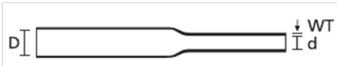
Abb. 1: Wärmeschrumpfschlauch, Schrumpfrate 2:1
