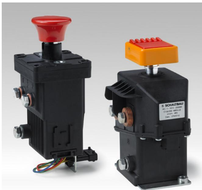
Ein einziges Gerät: Schaltbau hoch wirtschaftliche Kombischaltgeräte integrieren Hauptschütz, Notausschalter, Haupt- und Steuersicherungen sowie eine optionale Hupe. Haupteinsatzgebiet sind batteriebetriebene Flurförderzeuge, z.B. Gabel- und Schubmaststapler sowie Mitgängerfahrzeuge.
